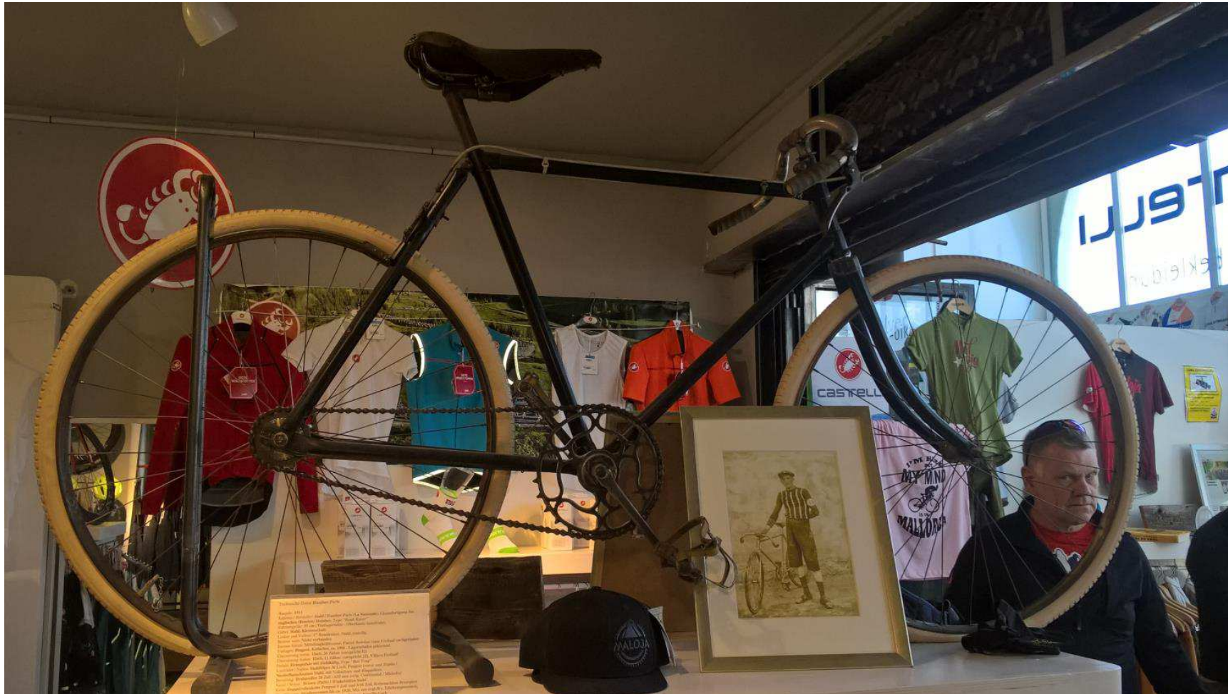
Stahlrad „Humber Paris“ Baujahr 1911: Übersetzung 26/11 => 52/22
